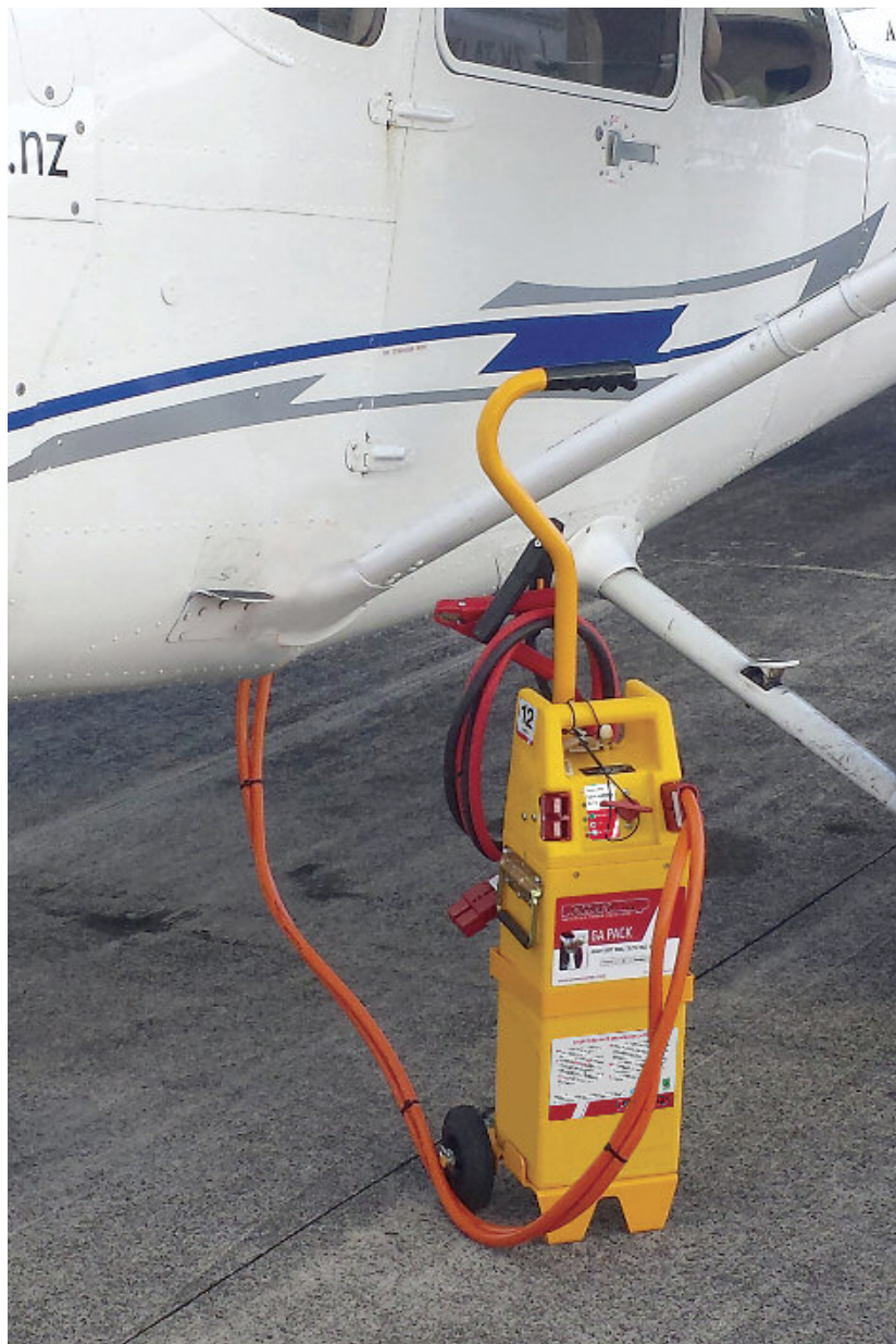
Pack 12/24V GA: Suministrando potencia a un Cessna 172R
