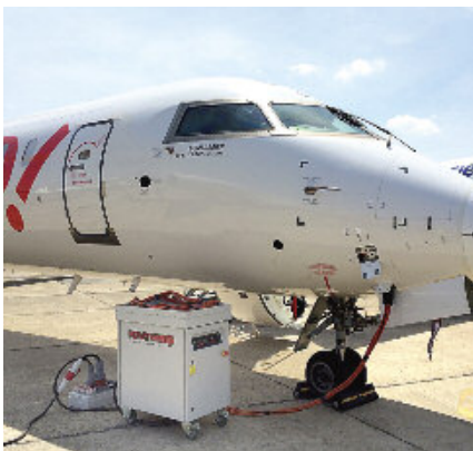
PV45: Suministrando potencia a un Bombardier CRJ1000
