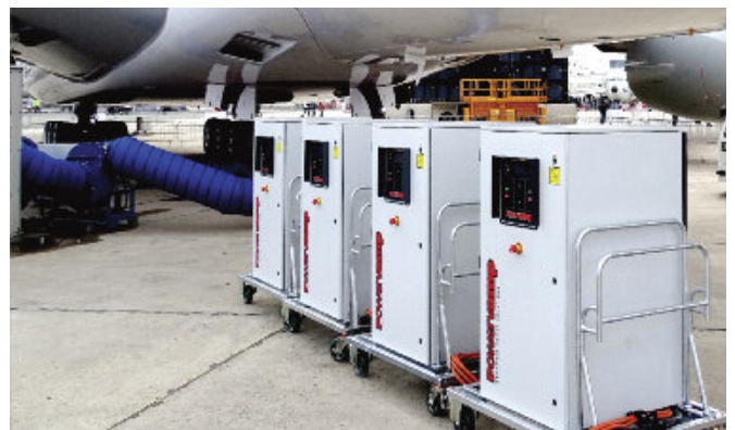
PV90-3: Equipo especificado para proporcionar potencia externa a las aeronaves en el Show Aéreo Internacional de Paris año 2015
