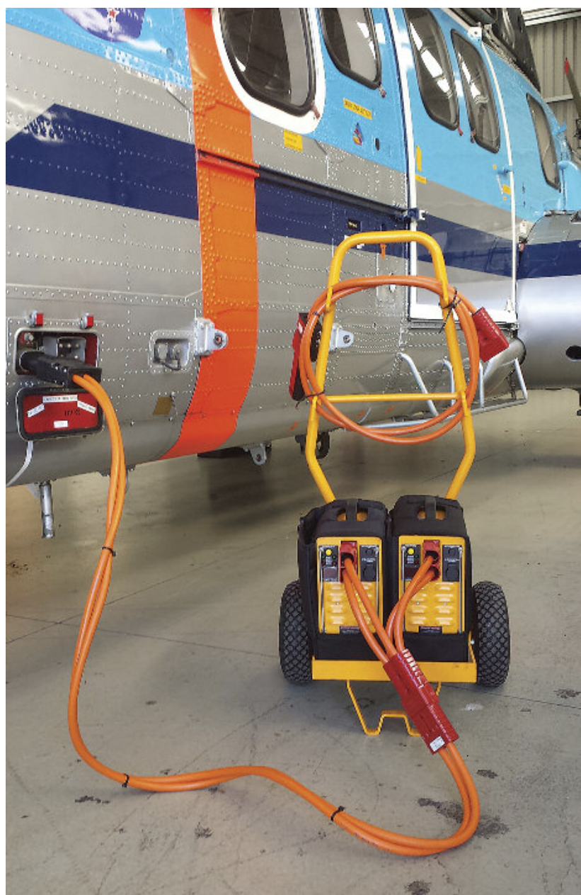
GPU 1500/40 Twin: Suministrando potencia a un Super Puma
